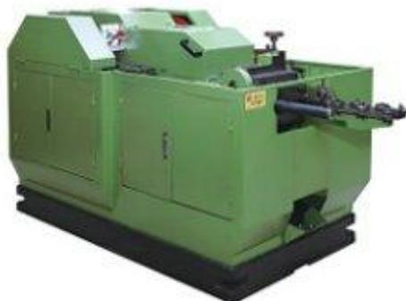
Непосредственным назначением холодновысадочного автомата является изготовление шурупов, саморезов и подобного материала из специальной стали, калиброванного типа, сама высадка материала происходит из прутков либо другой формы стального материала.
