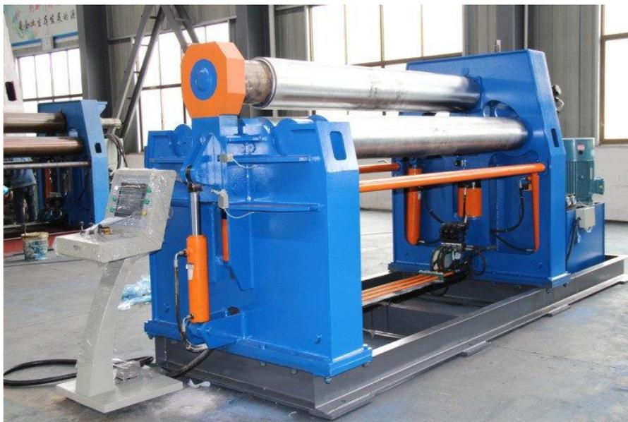
В конструкции этой листогибочной машины присутствуют самоцентрирующиеся роликовые подшипники, мотор редуктор, планетарный механизм для всех валков, а также гидроцилиндры.
