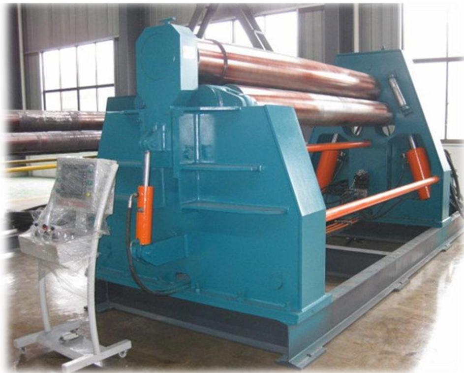
3-х валковая листогибочная машина серия HDLW11HX — привод валков осуществляется при помощи гидравлического мотора редуктора, крутящий момент обеспечивается через планетарный механизм для всех приводных валков, подъем-опускание боковых валков осуществляется при помощи гидроцилиндров по дуговым направляющим.
